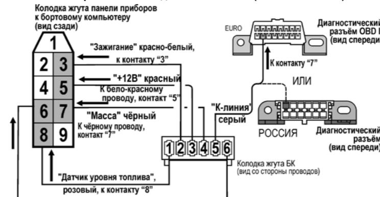
рис.9 Схема подключения "2110"(обычная панель)
