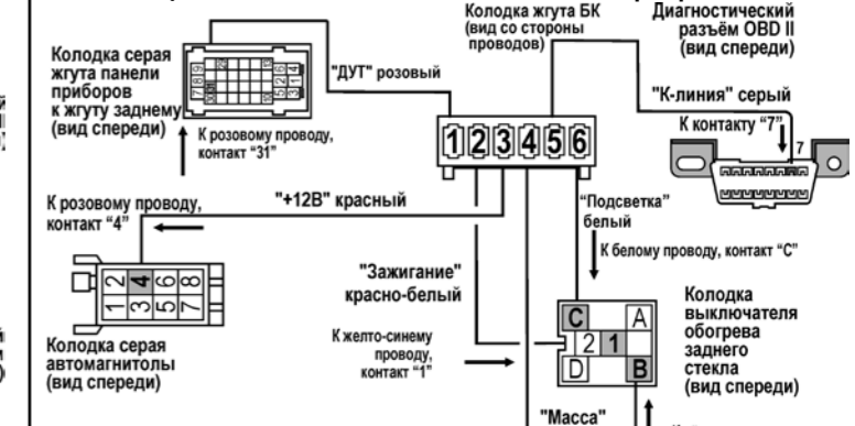
рис.13 Схема подключения ВАЗ 2170 "Приора"
