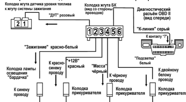
рис.11 Схема подключения ВАЗ-2110 панель приборов "люкс"
